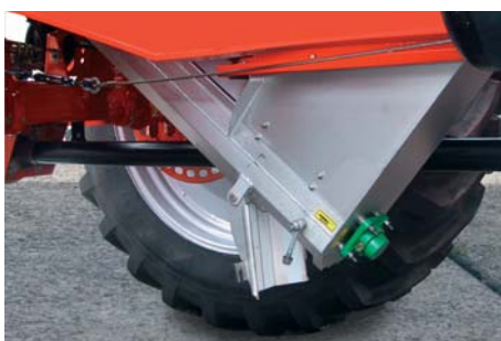
Den utanpåliggande och sensorövervakade skruven i rostfritt stål möjliggör en bra åtkomlighet även vid full tank.
