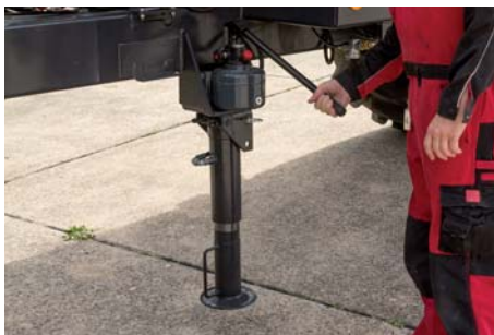
Det hydrauliska stödbenet underlättar av- och påkoppling.
