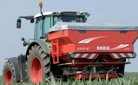
Mit der genialen, vollautomatischen EMC-Dosierautomatik misst und regelt AXIS den Düngerdurchfluss auf der linken und rechten Seite separat.
