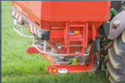
AXIS H - Randstreuen rechts und links durch Drehzahl- und Aufgabepunktverstellung
