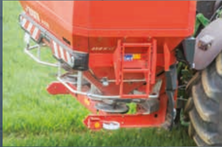
AXIS H - kantspredning høyre og venstre med turtalls- og nedslippspunktregulering
