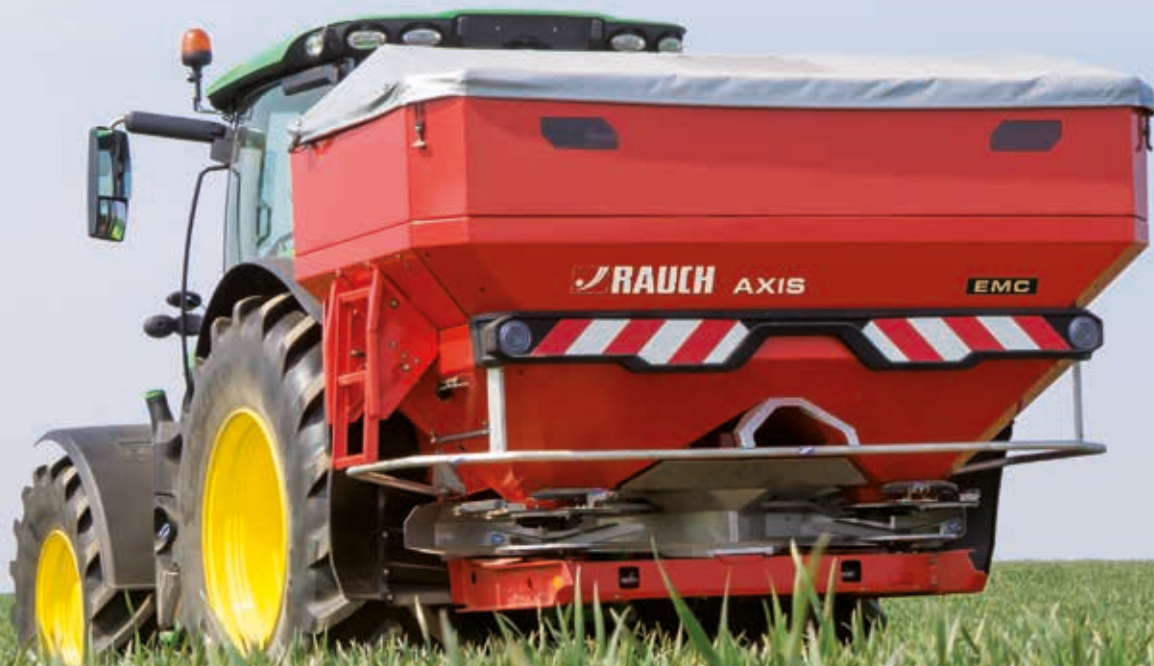
AXIS EMC - dreiemomentmåling med magnetstriksjonssensorer (kjent fra E-Bikes og Segways)
