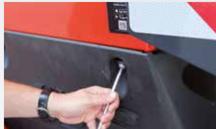
Грязеуловитель с быстродействующим фиксатором
