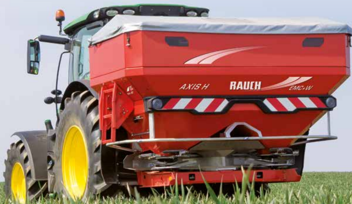
AXIS EMC - измерване на въртящия момент с магнитострикционни сензори (познати от електровелосипедите и сегуеите)
