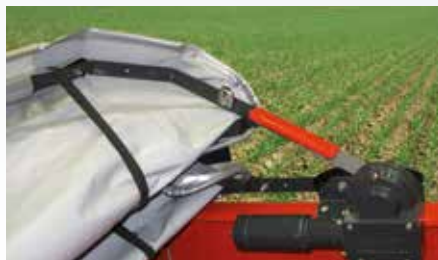
Електрически дистанционно управляеми покривала
