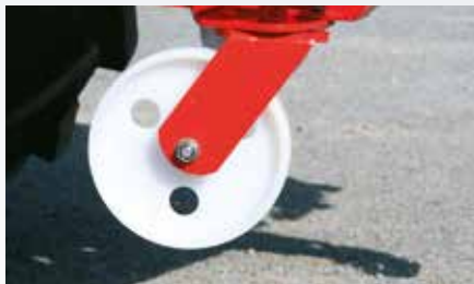
Спиращи ролки със система за бързо съединяване
