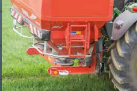
AXIS H - rajalevitys oikealla ja vasemmalla pyörimisnopeutta ja levityspistettä säätämällä
