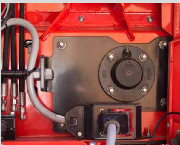
Tömített szalagtengely-csapágyazás és gyorscsatlakozók a szórómű elektronikájához
