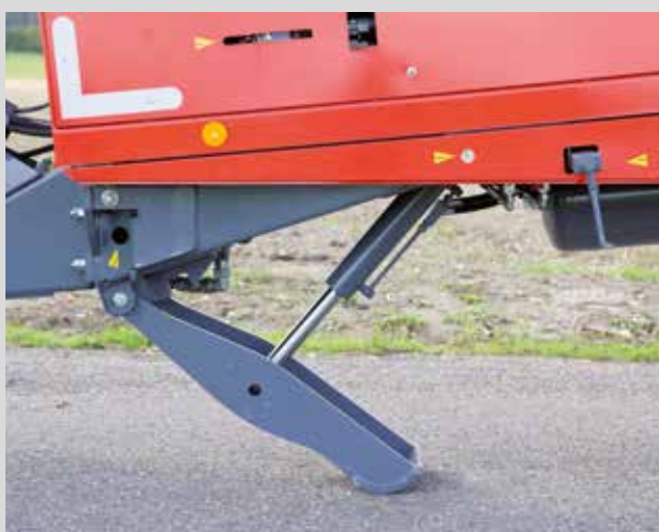
A hidraulikus támasztóláb gyors és megbízható alátámasztást biztosít
