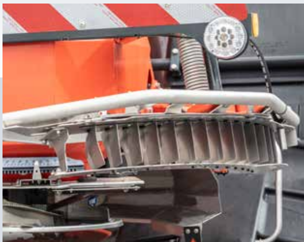
TELIMAT határszóró berendezés a pontos szóráshoz az első nyomvonalon haladva
