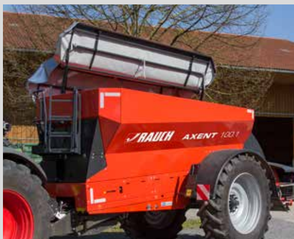
A takaróponyva megbízhatóan védi a szóróanyagot és könnyedén nyitható
