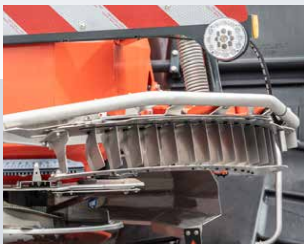
Urządzenie do wysiewu granicznego TELIMAT, do precyzyjnego wysiewu z pierwszej ścieżki przejazdu.
