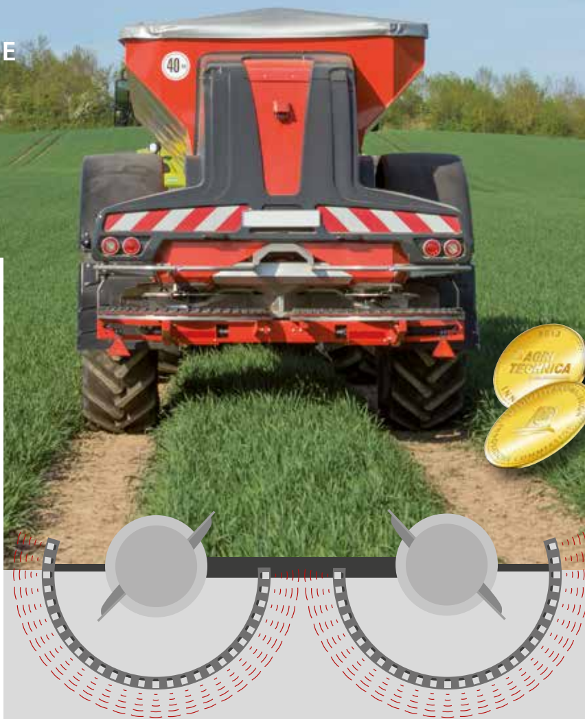
Precyzyjna analiza obrazu rozsiewania przez 54 czujniki radarowe
