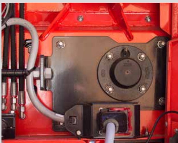
Uszczelnione łożyskowanie wału taśmy i szybkozłącze do elektroniki rozrzutnika.
