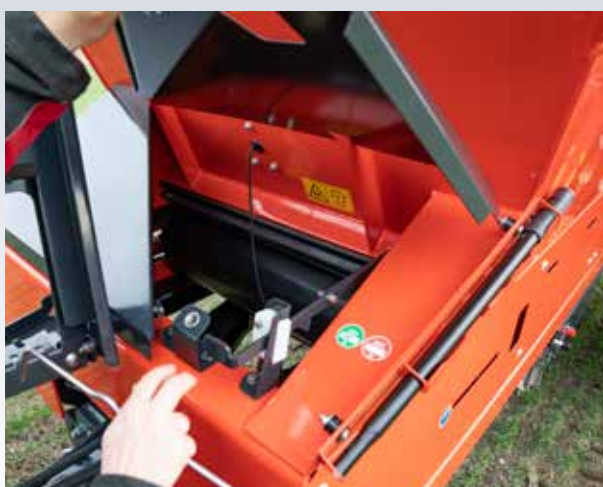
Komfortowa kontrola i czyszczenie dzięki łatwemu dostępowi przez klapę konserwującą.
