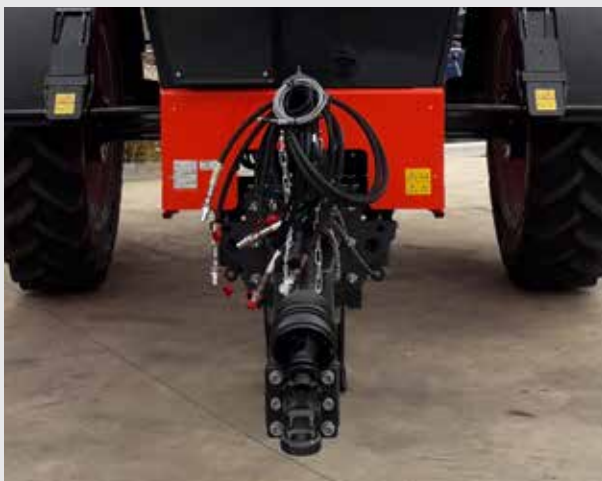
Разбрасыватель AXENT оснащается на выбор верхней или нижней сцепкой
