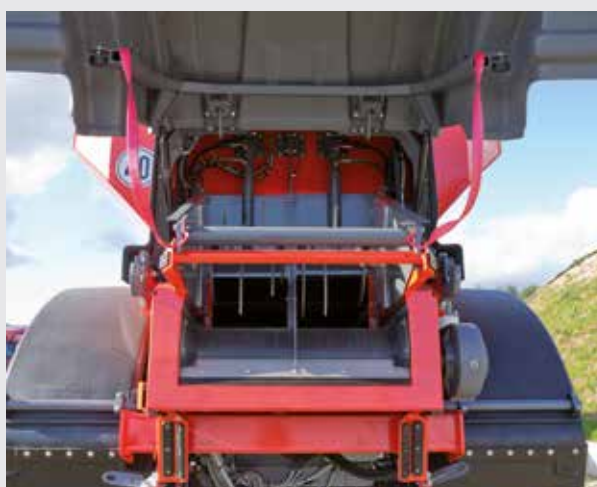
Сервисная крышка с газовой пружиной
