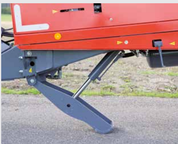
Гидравлическая опора обеспечивает быструю и надежную стабилизацию
