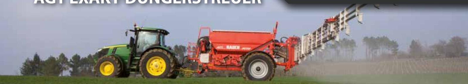
Das Konzept des pneumatischen Düngerstreuers AGT 6036 überzeugt durch seine unschlagbare Dosier- und Verteilgenauigkeit. Nicht umsonst nennt man diese Technik auch „Exaktstreuer“. Durch die Zwangsdosierung über Nockenradwalzen und die Verteilung
