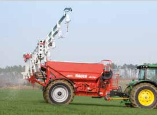
Die Höhe des Gestänges spielt beim Düngerstreuer im Gegensatz zur Feldspritze eine untergeordnete Rolle. Das System ist so ausgelegt, dass ab einer Arbeitshöhe von 1,0 m über den Pflanzen jeder Krümmer sich mit seinem Nachbarn überlappt, je höher der Ausleger geführt wird, desto größer wird die Überlappung. Die Höhe des Auslegers ist nicht ausschlaggebend und sollte so eingestellt werden, dass noch
