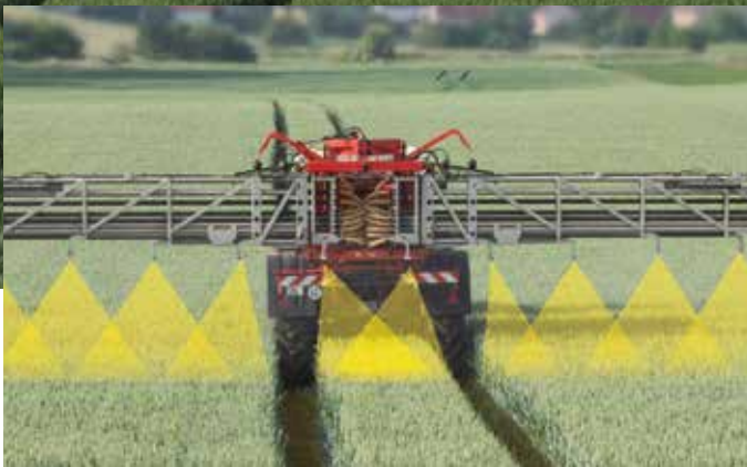
Fahrgassen werden beim Düngen ausgespart
