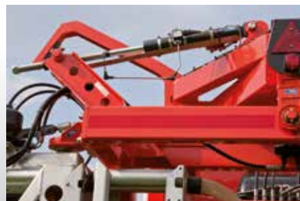
Distance Control: Automatische aktive Auslegerführung
