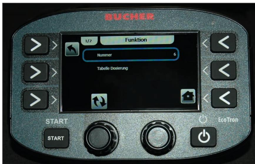
Alla voce di menu **“Funzione”** nella scheda **“Numeri”** si possono impostare fino a 20 punti di pesatura. Si consigliano 6 punti di pesatura. Più sono i punti di pesatura, più la macchina funziona in modo preciso.
