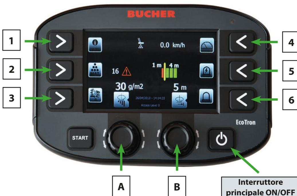
L'unità di comando viene accesa e spenta con l'interruttore principale (in basso a destra). Durante l'avvio del sistema viene visualizzato il logo Bucher, dopodiché appare il menu di avvio.
