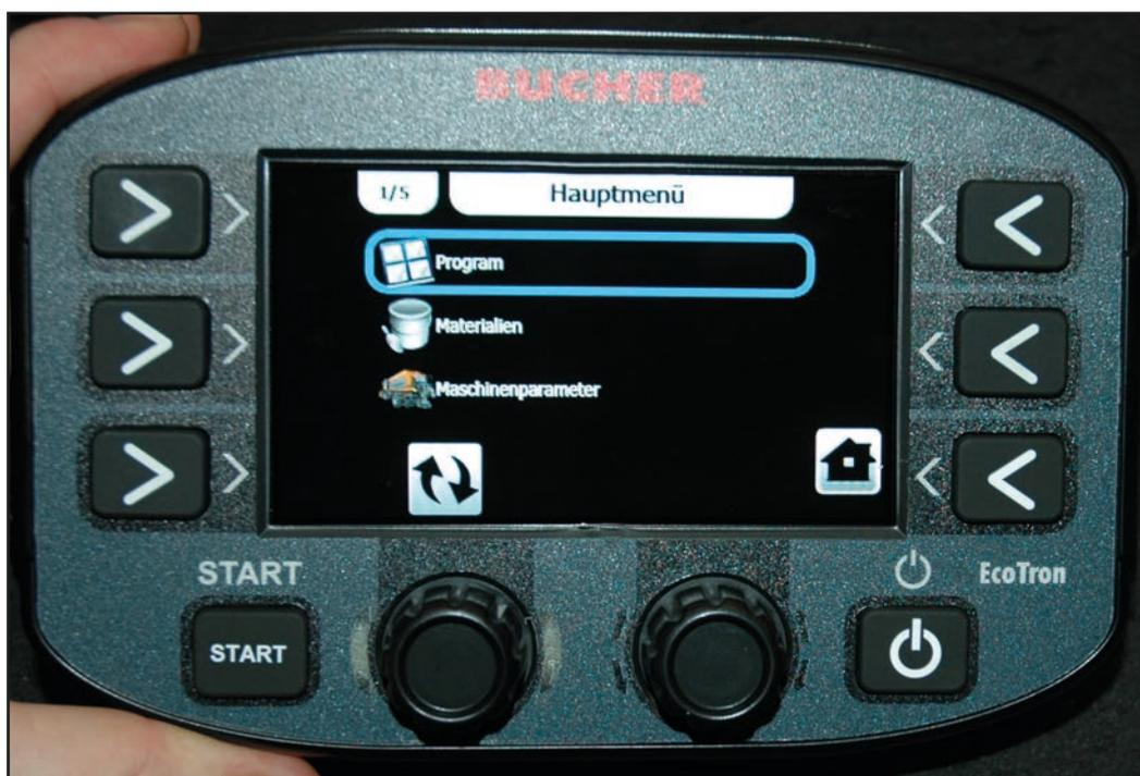
Premere a lungo il tasto "Menu" e inserire la password per accedere ai menu del conducente e di allineamento.
