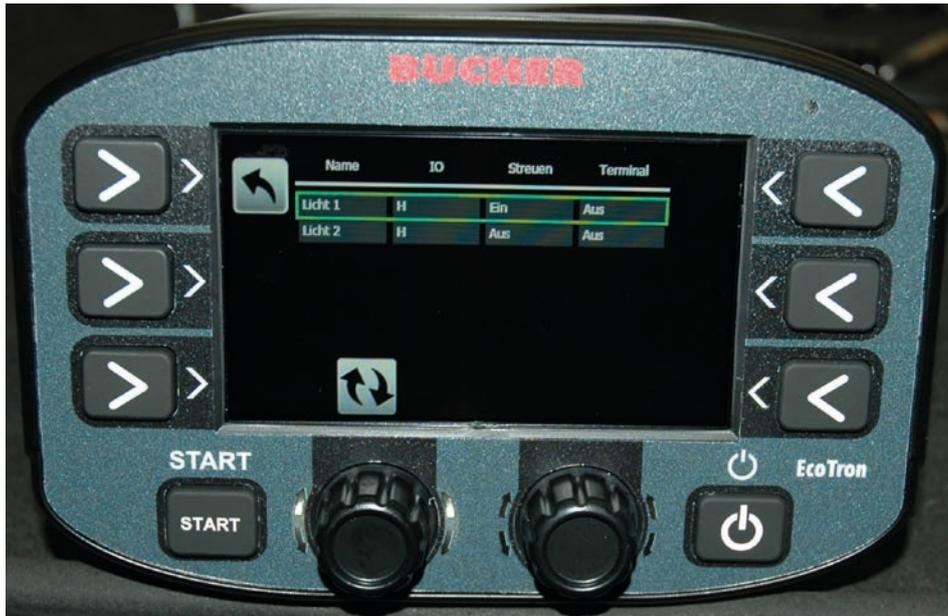
Con l'unità di comando EcoTron è possibile controllare due diversi sistemi di illuminazione. Nella seconda colonna della tabella si può attivare la rispettiva uscita mediante l'impostazione H (High). Nelle due colonne seguenti è possibile selezionare se la rispettiva luce si accende appena viene attivata la modalità di spargimento (colonna 3) o se si accende all'accensione del terminale (colonna 4). Le luci devono essere collegate alle uscite corrispondenti nella scatola di distribuzione.
