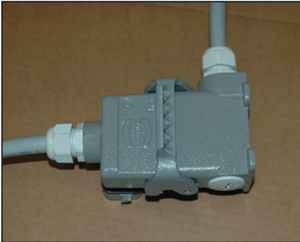
Per determinati veicoli è previsto un separatore di cavi (a 15 poli) dietro la cabina.
