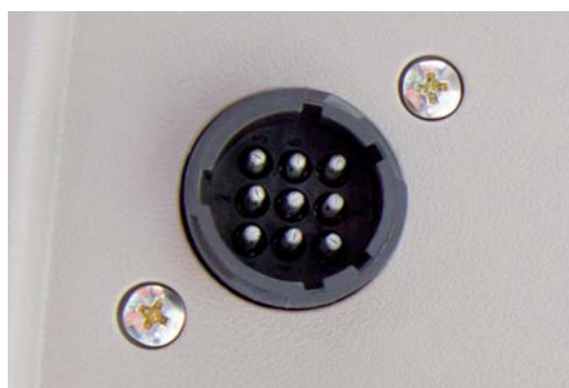
Rysunek 3.2: 9-stykowe gniazdo terminalu ISOBUS w kabinie
