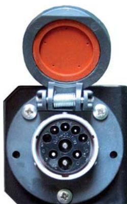
Rysunek 3.1: 9-stykowe gniazdo ISOBUS w tylnej części ciągnika
