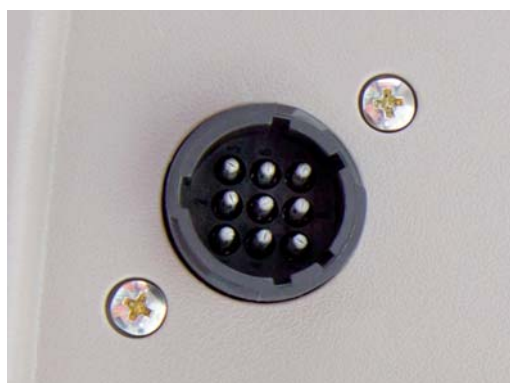
Obrázek 3.2: 9pólová terminálová zásuvka ISOBUS v kabině
