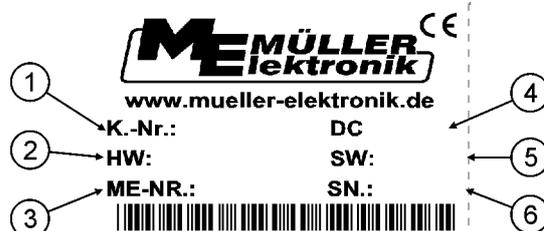
Фирменная табличка на задней стороне терминала
