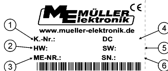
Plaque d'identité sur la face arrière du terminal
