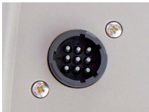
Bild 3.2: 9-polige ISOBUS Terminal-Steckdose in der Kabine
