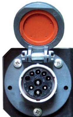
Bild 3.1: 9-polige ISOBUS Steckdose am Traktorheck
