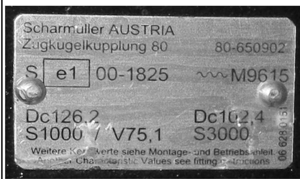
Placa de fábrica del enganche para remolques
