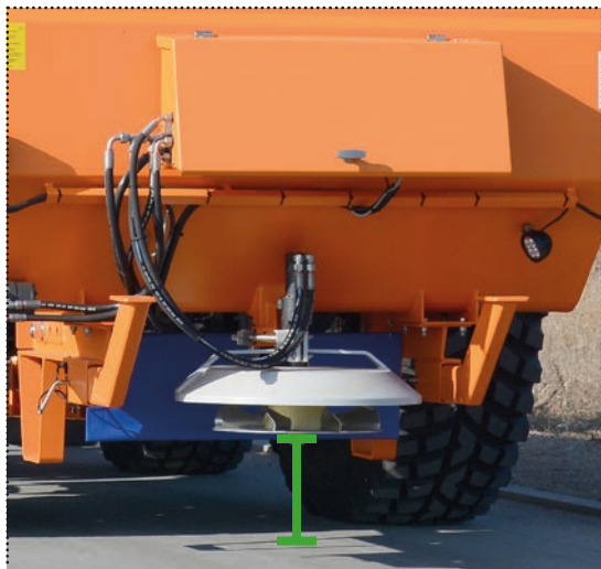
Wysokość robocza: talerz rozrzucający w odległości od 35 cm do 45 cm nad podłożem
