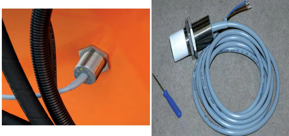
Il sensore di vuoto si trova nella parte posteriore della macchina, a sinistra dell'elemento spargitore.
