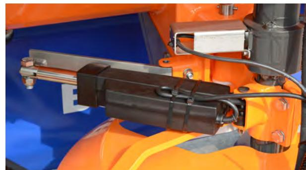
III. 5: Regolazione elettronica dello schema di spargimento
