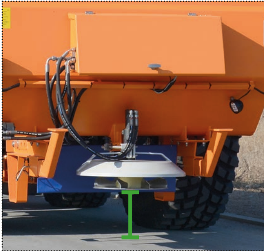
Altezza di lavoro: disco spargitore a 35 cm - 45 cm da terra
