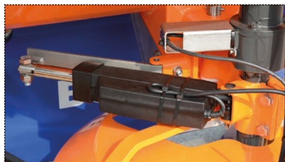
Regolazione elettronica dello schema di spargimento
