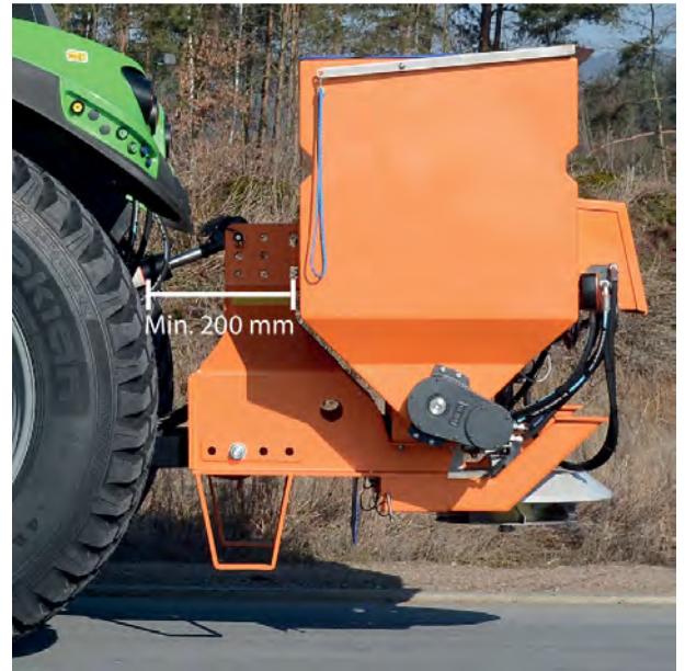
Afb. 2: Veiligheidsafstand: ten minste 200 mm
