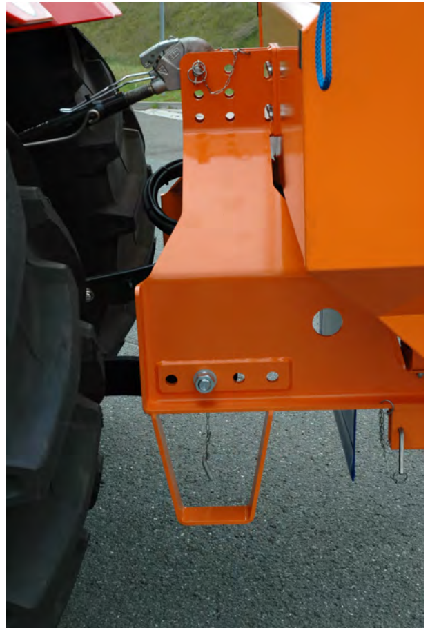
Afb. 1: De machine is correct gepositioneerd en de topstang is correct ingesteld.
