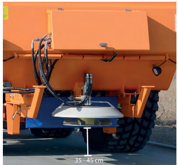
Afb. 3: Arbeidshoogte: strooischijs 35 cm tot 45 cm boven de grond
