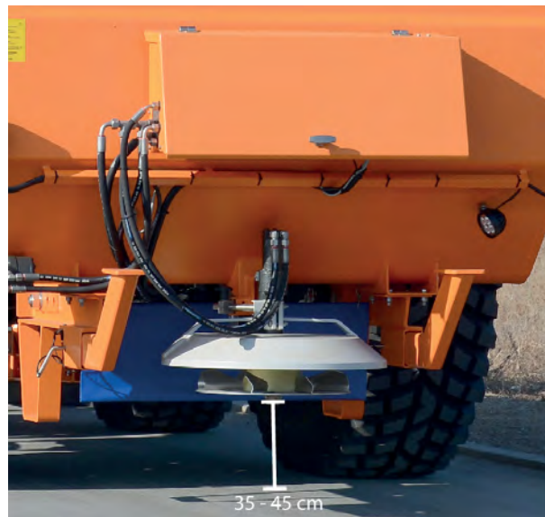
Fig. 3: Arbejdshøjde: Spredetallerken 35 cm til 45 cm over jorden
