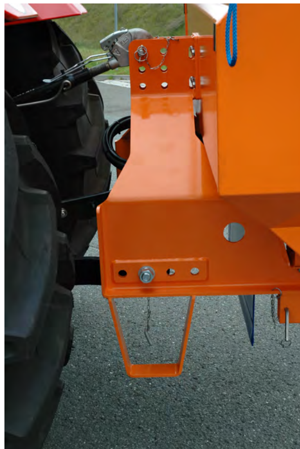
Fig. 1: Maskinen er positioneret korrekt, og topstangen er indstillet korrekt.
