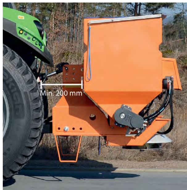
Fig. 2: Sikkerhedsafstand: mindst 200 mm
