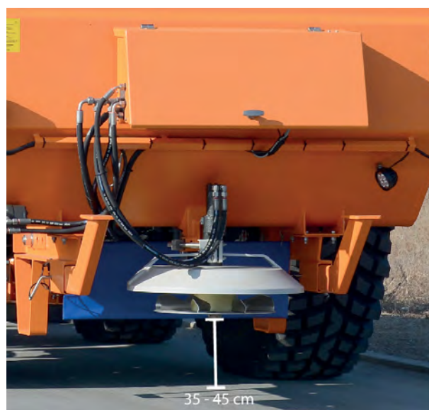
Fig. 3: Hauteur de travail : disque d'épandage située entre 35 cm à 45 cm du sol
