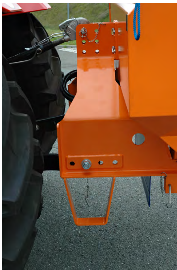
Fig. 1: La machine est bien positionnée et le bras supérieur d'attelage est bien réglé.
