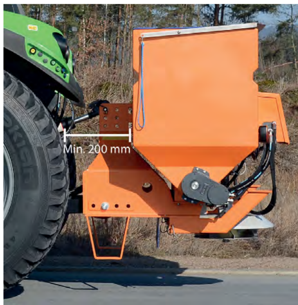
Fig. 2: Distance de sécurité : au moins 200 mm
