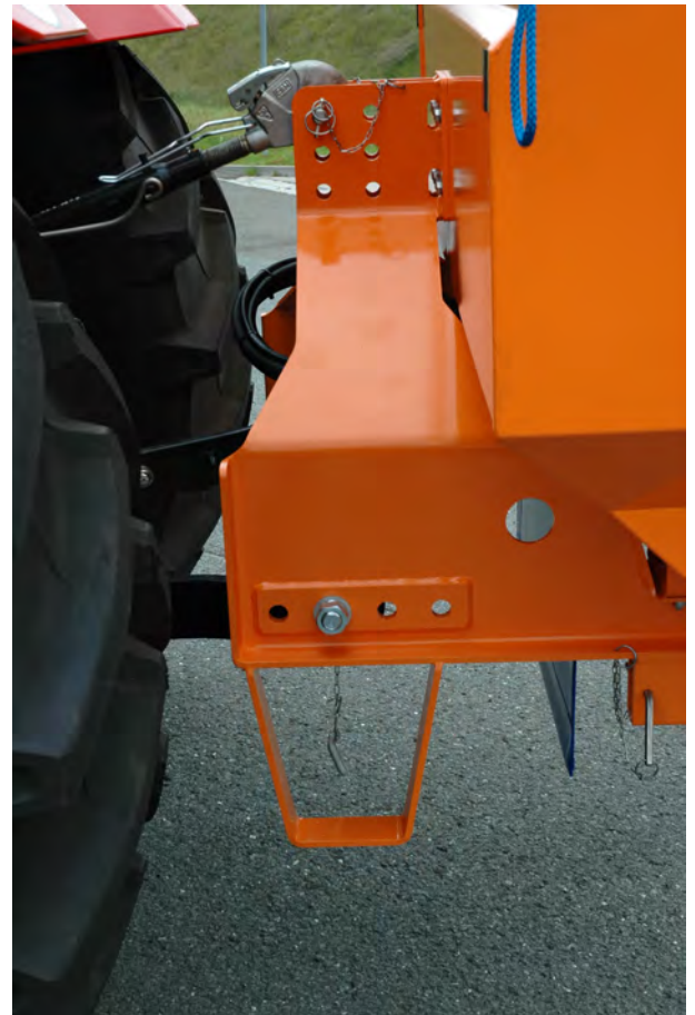
Abb. 1: Die Maschine ist richtig positioniert und der Oberlenker ist richtig eingestellt
