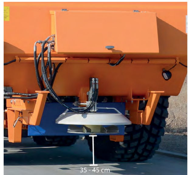
Abb. 3: Arbeitshöhe: Streuteller 35 cm bis 45 cm über dem Boden
