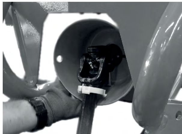
Fig. 14: Plugg kardangakselen på kraftuttaket
