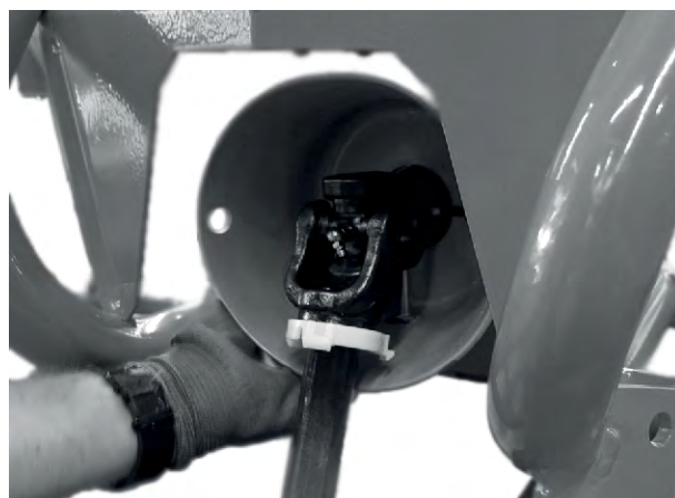
III. 14: Inserimento dell'albero cardanico sul perno del riduttore
