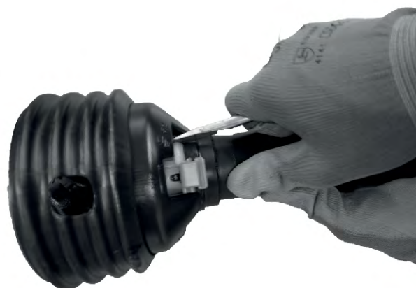
Ill. 13: Apertura della protezione dell'albero cardanico
