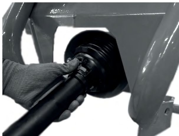
III. 16: Applicazione della protezione dell'albero cardanico
