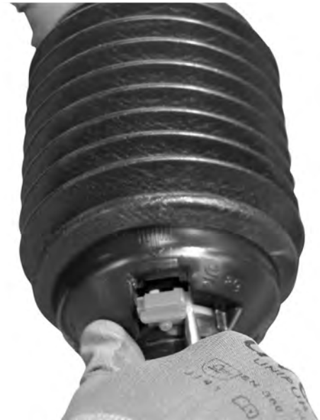
Att. 15: Atveriet kardānvārpstas aizsargu
