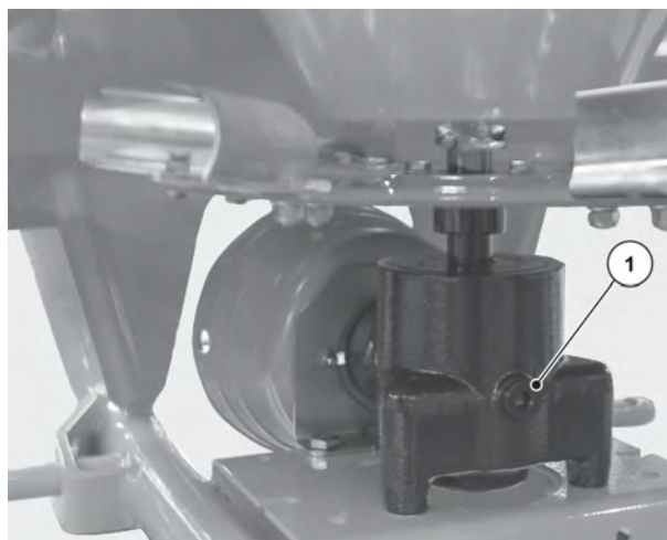
Obr. 34: Kontrolní šroub hladiny oleje v převodovce
