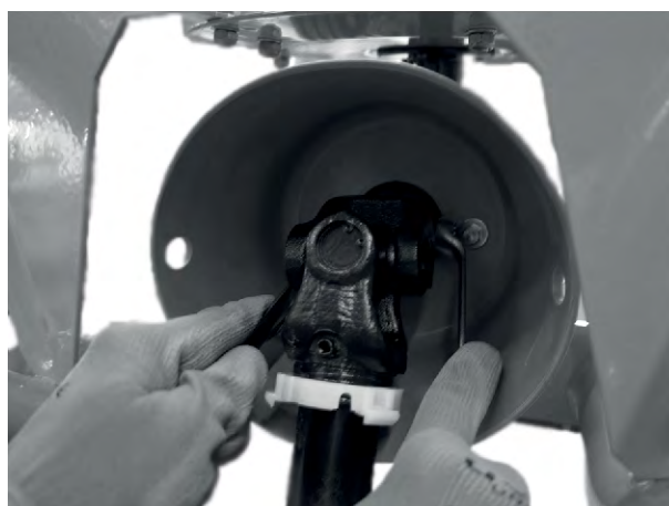
Obr. 15: Spojení kloubového hřídele
