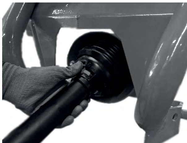
Obr. 16: Montáž krytu kloubového hřídele
