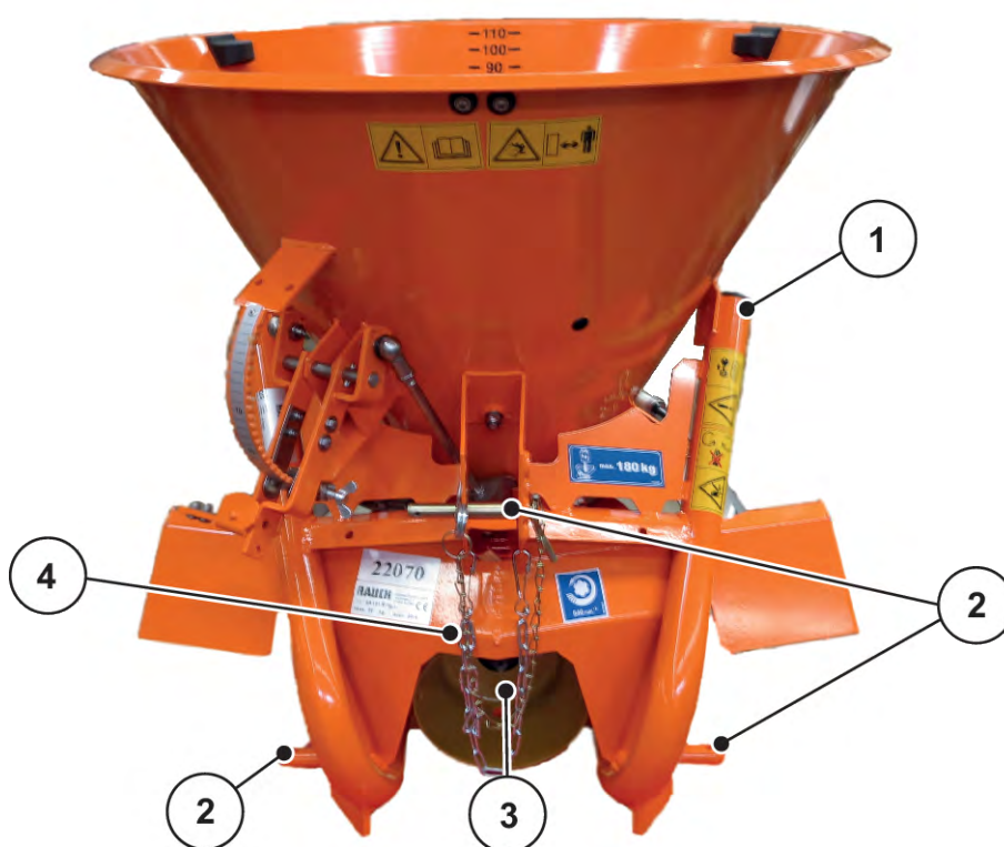
Obr. 7: Přehled konstrukčních skupin: Přední strana
