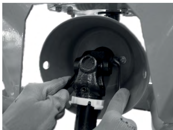
Ábr. 15: A kardántengely összekötése
