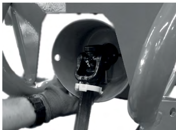
Ábr. 14: A kardántengely feltolása a hajtócsapra
