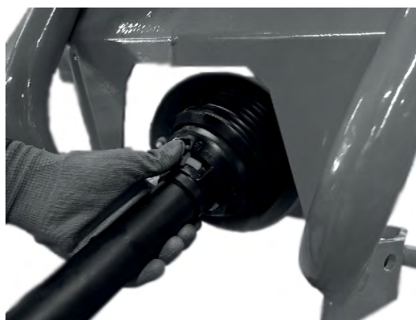
Ábr. 16: Kardántengelyvédő felhelyezése
