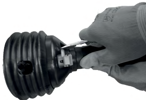
Ábr. 13: Kardántengelyvédő nyitva
