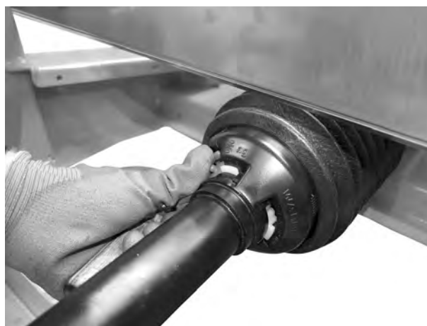
Ilust. 19: Asegurar la protección del eje articulado
