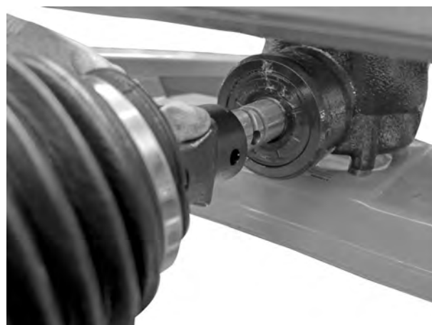
Ilust. 16: Inserción del eje articulado en el muñón de engranaje
