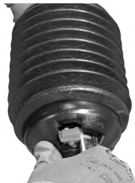
Ilust. 15: Abrir la protección del eje articulado
