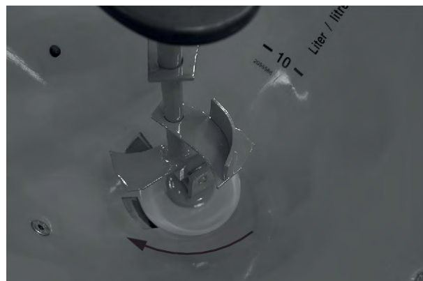
Ilust. 38: Contenedor sin rejilla protectora
