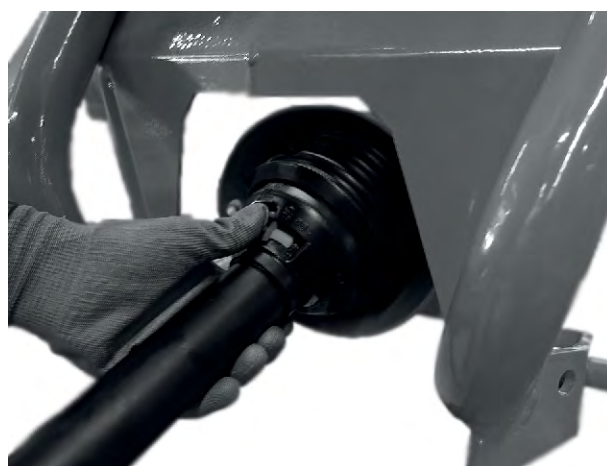
Fig. 16: Påsætning af kardanaxselbeskyttelsen
