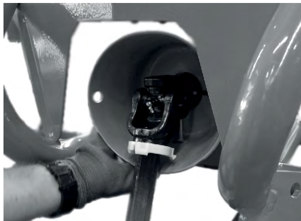
Fig. 14: Montage de l'arbre de transmission sur l'axe de l'engrenage
