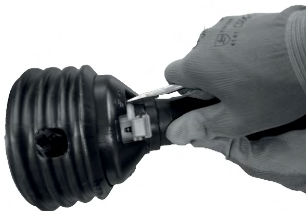
Fig. 13: Ouverture de la sécurité de l'arbre de transmission
