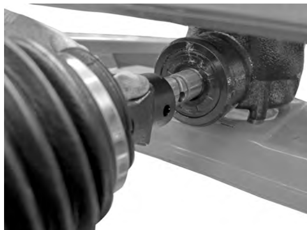
Fig. 16: Montering af kardanaxslen på akseltappen
