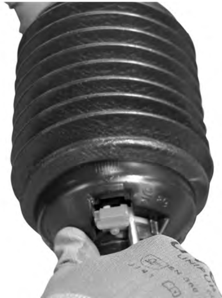
Kuva 15: Nivelakselin suojuksen avaaminen
