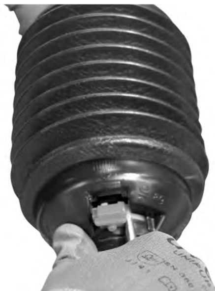
III. 15: Aprire la protezione dell'albero cardanico
