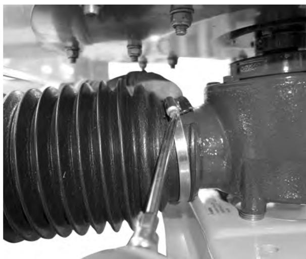
*III. 16: Applicazione della protezione dell'albero cardanico*
