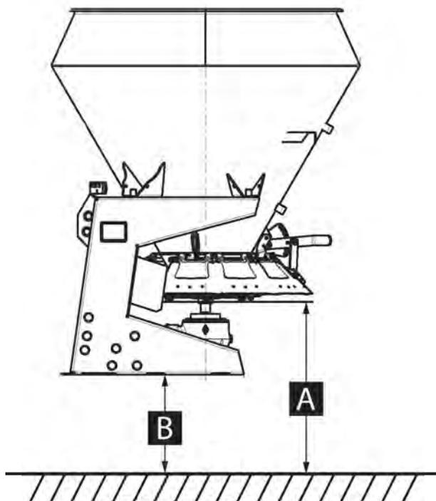
III. 19: Determinare l'altezza di montaggio
