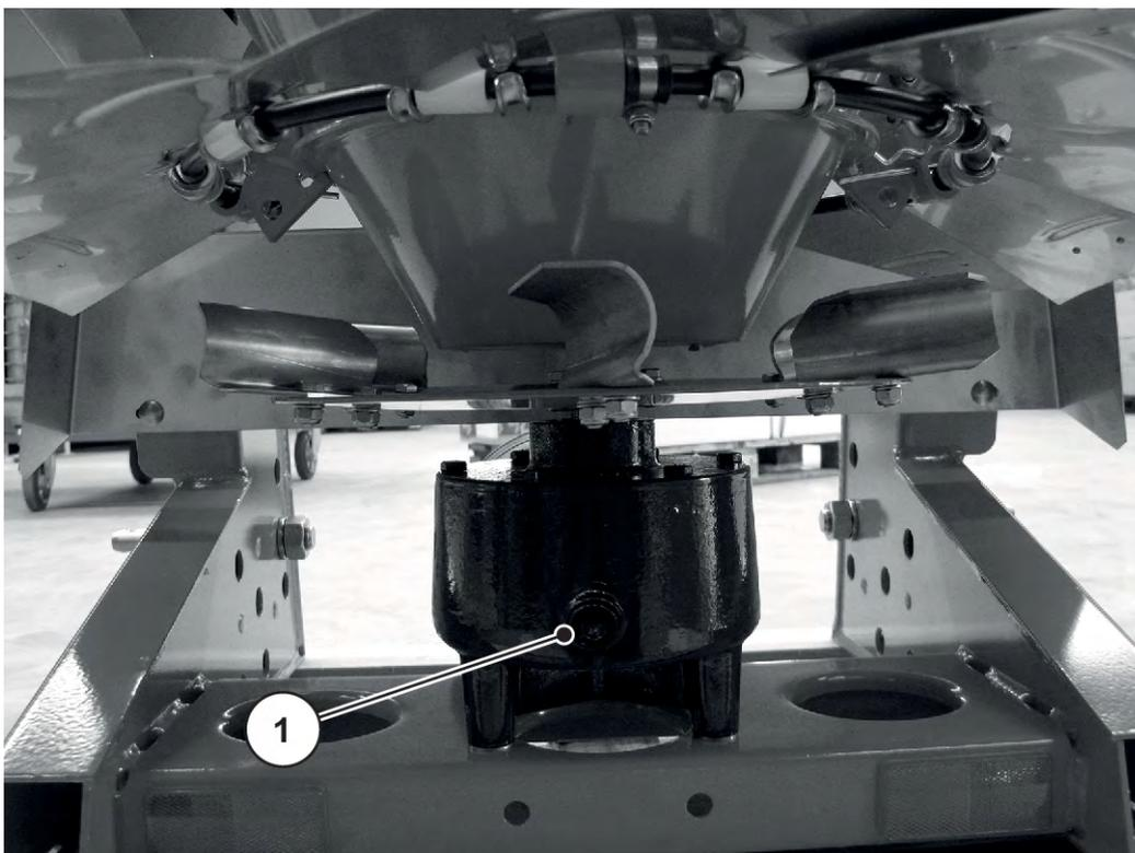
*Ill. 39: Vite per il controllo del livello dell'olio nel riduttore*
