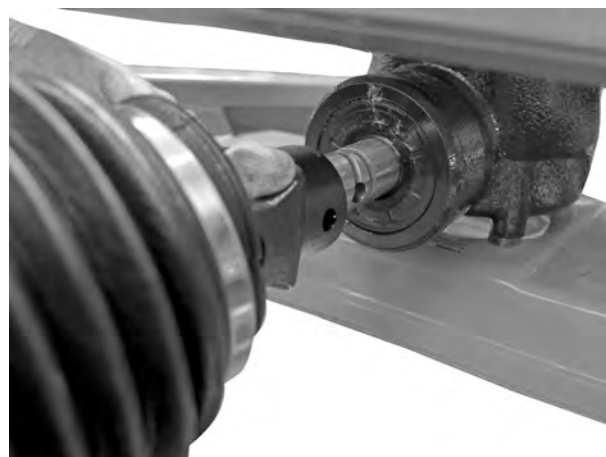
Fig. 16: Montage de l'arbre de transmission sur l'axe de l'engrenage
