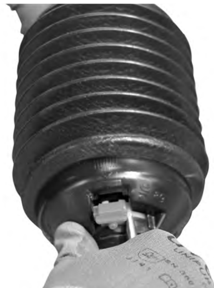
Fig. 15: Ouverture de la sécurité de l'arbre de transmission
