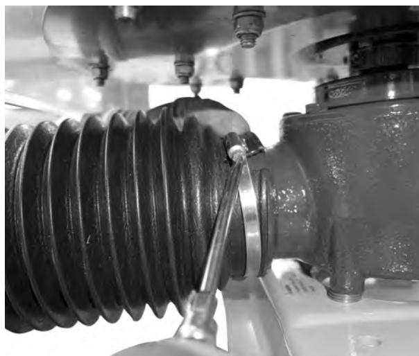
Fig. 18: Mettre la sécurité de l'arbre de transmission en place
