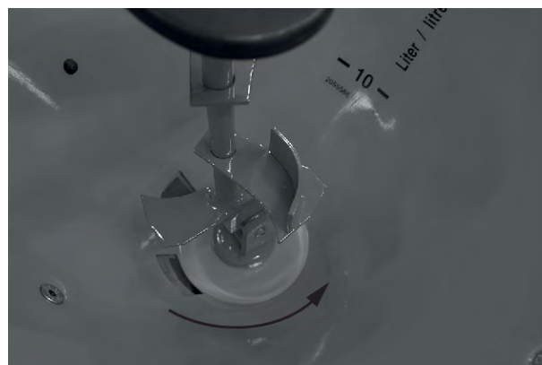
Fig. 23: Le montage de l'agitateur est terminé
