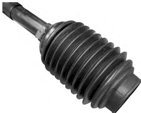
Fig. 3: Protection de l'arbre à cardan
