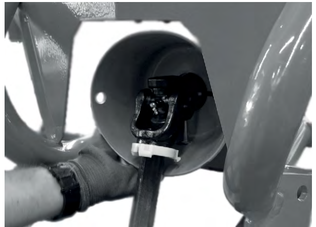
Abb. 14: Gelenkwelle auf Getriebezapfen aufstecken
