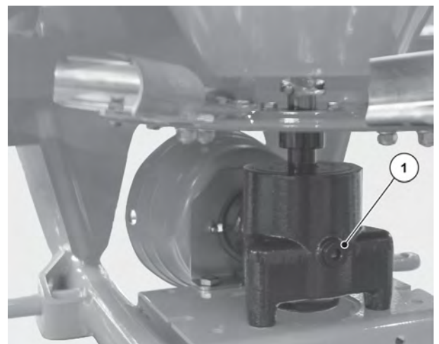
Abb. 34: Kontrollschraube für Getriebe-Ölstand
