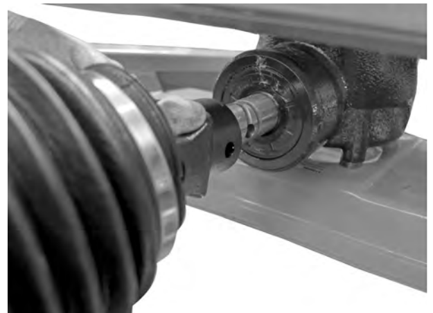
Abb. 16: Gelenkwelle auf Getriebezapfen aufstecken
