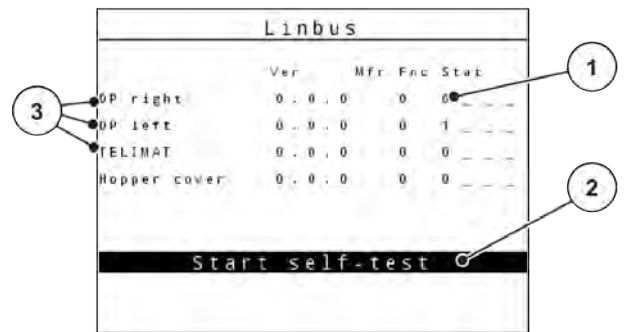
Şek. 44: Test/Arıza teşhisi; örnek: LIN veriyolu
