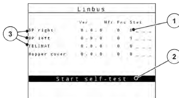
Sl. 44: Preizkus/diagnostika; primer: Vodilo LIN
