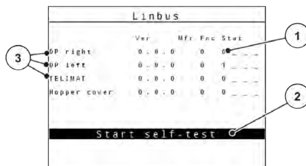
Obr. 44: Test/diagnostika; príklad: Zbernica LIN
