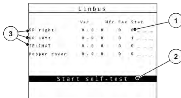
Jn. 44: Test/diagnostika; näide: LIN-siin
