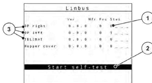
Fig. 44: Test/Diagnos; exempel: Linbus
