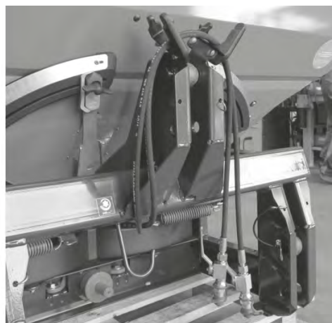
Рис. 60: Місце для зберігання карданного вала, місце для зберігання кабелів і шлангів гідравлічної системи
