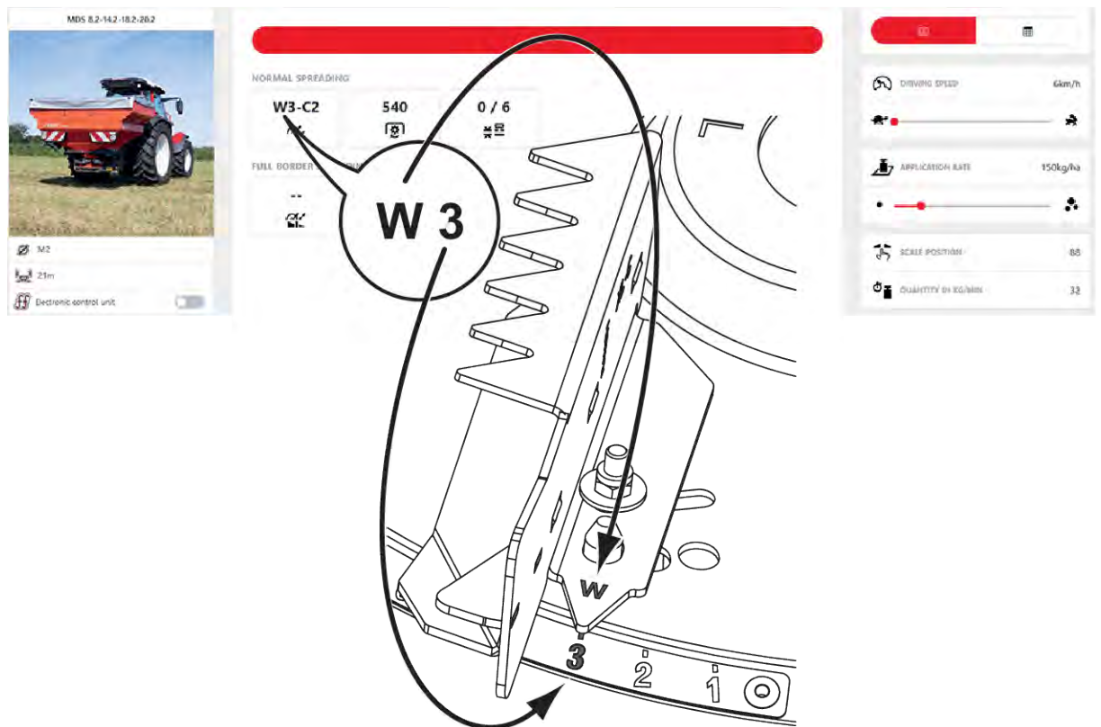
図 44: 散布ブレードの調節 散布ディスク M2、位置 W3、W: 固定長調節 1~6: 角度
