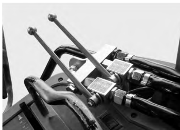
図 30: ツーウェイユニットのスライドアクチュエーター
