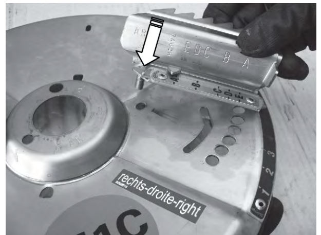
図 92: メインブレードの取付け
