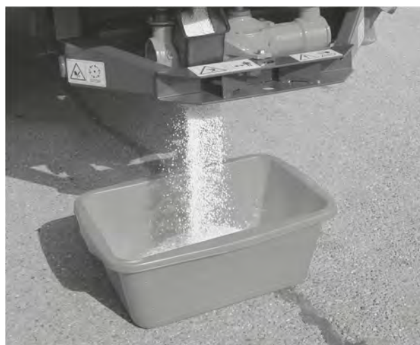
図 39: キャリブレーションテストの実施
