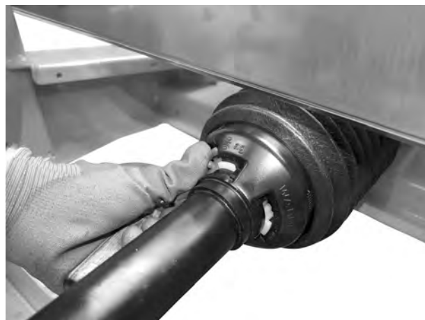
図 17: ジョイントシャフトガードを固定する
