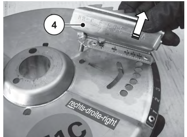
図 91: 散布ブレードを外す
