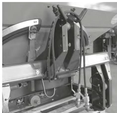
図 62: ジョイントシャフトの保管、ケーブルと油圧ホースの保管
