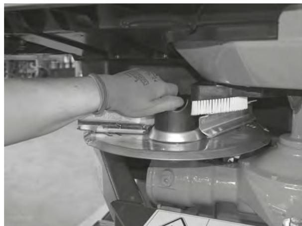
図 38: キャップナットを締める
