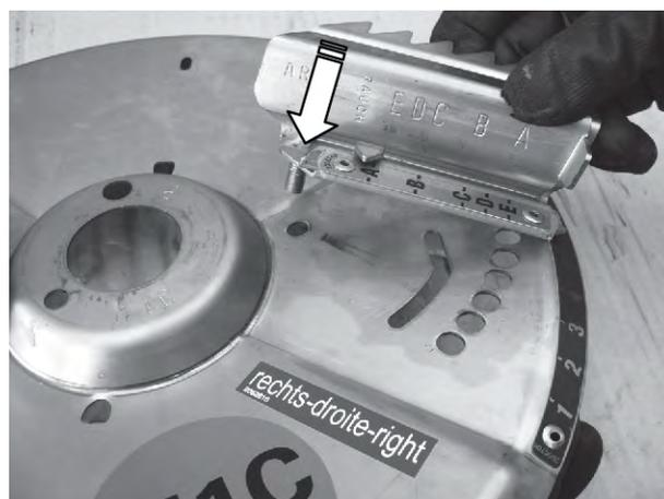
図 90: メインブレードの取付け
