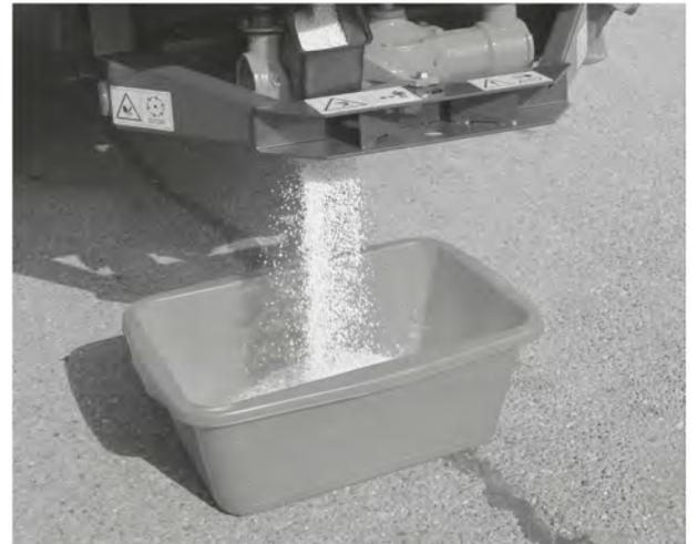
図 37: キャリブレーションテストの実施
