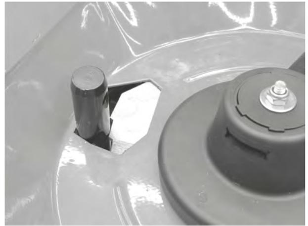
図 68: 調量アウトレットのロアリンクピン
