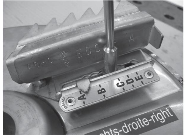
図 85: 散布ブレードの固定ポイント
