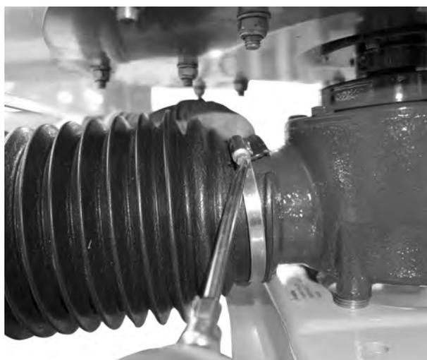
図 14: ジョイントシャフトガードを設置する
