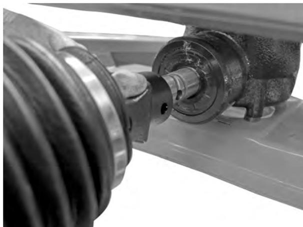
図 12: ジョイントシャフトをギアジャーナル上に差し込む
