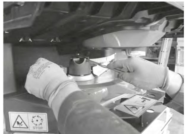
図 35: キャップナットをゆるめる
