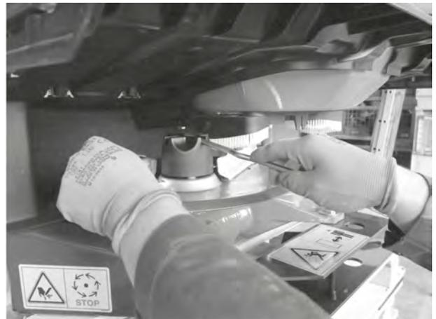
図 76: キャップナットをゆるめる
