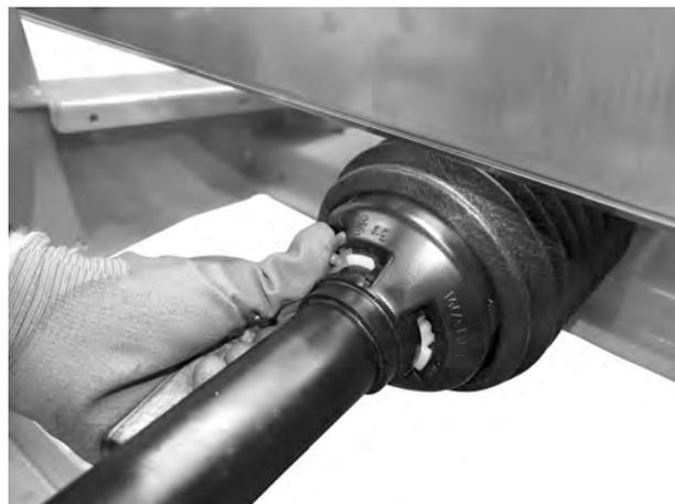
図 15: ジョイントシャフトガードを固定する
