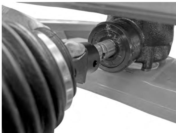
Obr. 14: Nasadenie kĺbového hriadeľa na výstupný hriadeľ prevodovky
